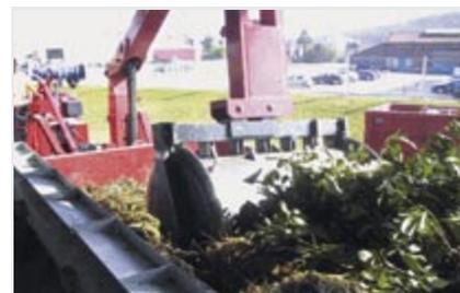
Ill. 4 : Compacter permet d'augmenter de 66 % la capacité d'une benne.
